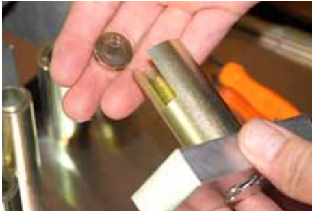
15. Remove spacer B.
